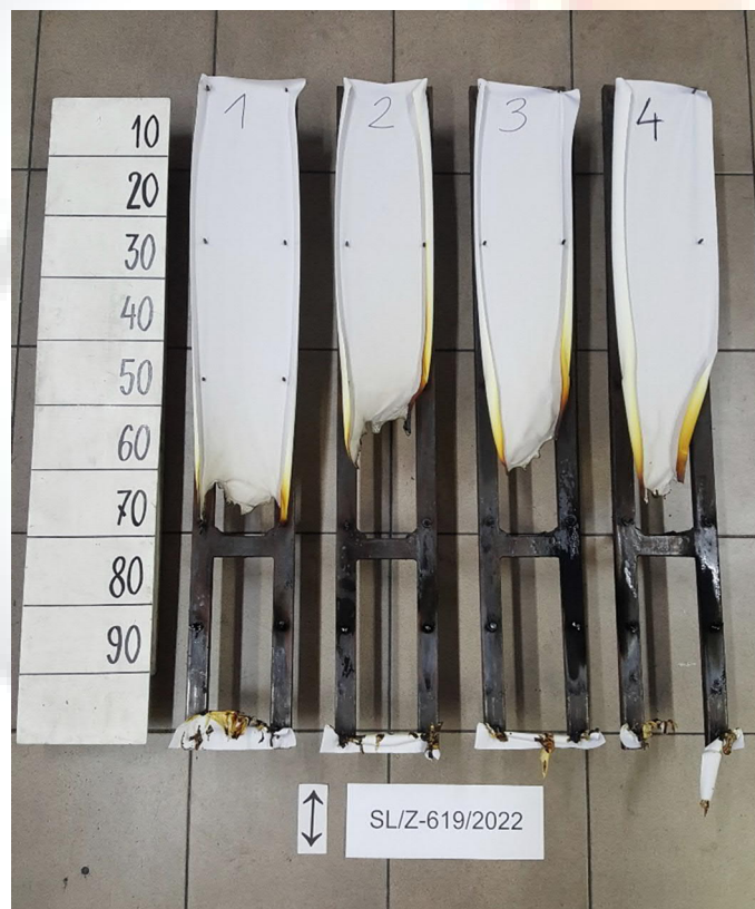
Rys. 2. Wygląd próbek 1 po badaniu – wzdłużny kierunek wytwarzania
