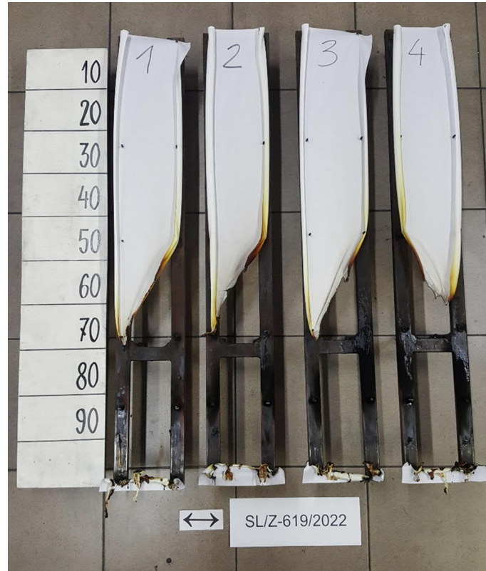
Rys. 3. Wygląd próbek 2 po badaniu – poprzeczny kierunek wytwarzania
